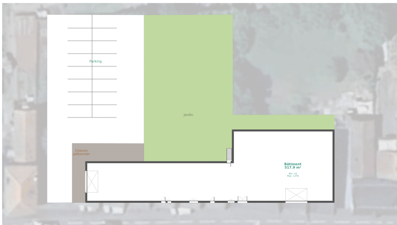
Exemple de calepinage de 16 places de stationnement
